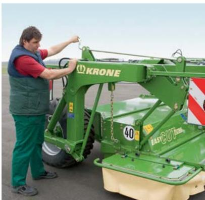
El control de la altura es rápido y cómodo: gracias a las manivelas que definen la altura de corte de forma continua e independientemente en cada unidad.
