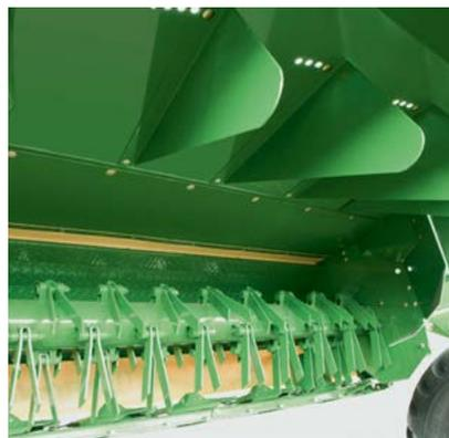
Forraje de calidad máxima: el rotor del acondicionador de alta capacidad con mayales de acero en V oscilantes y engranaje mecánico acondiciona el forraje por todo el ancho de trabajo a 600 rpm o 900 rpm. Los deflectores opcionales dirigen el flujo de la materia para su esparcido por todo el ancho y secado rápido.
