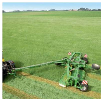
EasyCut 6210 CV – una segadora, dos barras de corte independientes. Esta segadora de alta capacidad con lanza central genera unos cortes perfectos con un ancho de trabajo de 6,20 m
