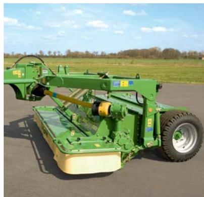
Adaptable: la segadora oscila en un bastidor doble para disponer de un desplazamiento vertical completo que le permite salvar obstáculos y adaptarse a las ondulaciones del terreno. La respuesta del sistema se controla mediante la tensión de los muelles. Cuanto mayor sea la tensión, más capacidad de respuesta tiene el sistema.
