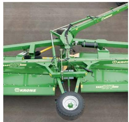
Desplazamiento a izquierda y derecha: la barra de tracción de montaje medio gira por medios hidráulicos a cualquier lado del tractor. Su cilindro de doble efecto es fiable incluso en las condiciones más difíciles.
