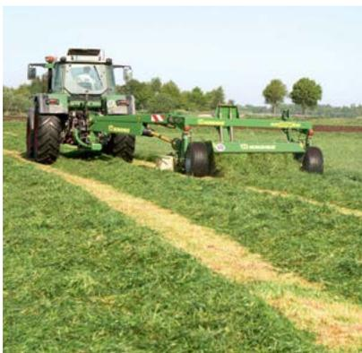
Los modelos EasyCut 2801 CV, 3200 CV, 3201 CV, 3200 CRi y 3600 CV con lanza lateral trabajan sin interrupciones, incluso en curvas y esquinas, sin necesidad de abandonar la posición de trabajo ni desplazarse marcha atrás.
