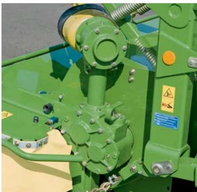
La barra de corte y el acondicionador comparten el mismo grupo, la cual también integra la caja de cambios mecánica del acondicionador CV de dos velocidades (600 rpm y 900 rpm).
