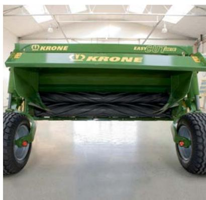
EasyCut 2800 CRi, 3200 CRi y 3210 CRi con rodillos de acondicionamiento. Los rodillos de ancho completo y perfil en cuña se interbloquean y proporcionan un tratamiento excelente a las leguminosas y la materia vegetal con hojas.
