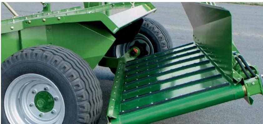
Un sistema sin atascos. La correa de 900 mm dispone de barras de transporte soldadas que proporcionan un flujo constante de la materia vegetal y cortes rápidos con materias vegetales pesadas, a la vez que forma hileras uniformes que constituyen una presentación excelente para el pick-up de la cosechadora posterior. Sistema hidráulico independiente: el suministro de aceite del agrupador de hileras procede de un depósito de aceite separado, en lugar del sistema hidráulico del tractor.
