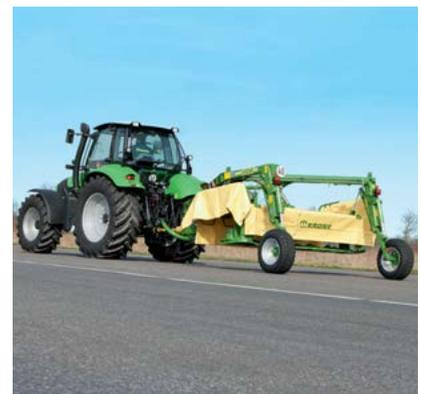
Elegante y compacto. Al desplazarse alineada detrás del tractor, EasyCut 3200 no supera el ancho de transporte legal de 3,00 m, dispone de una gran separación del suelo y está aprobada para desplazamientos a una velocidad máxima de 40 km/h. Esta es la máquina para desplazarse con rapidez de un lugar a otro.
