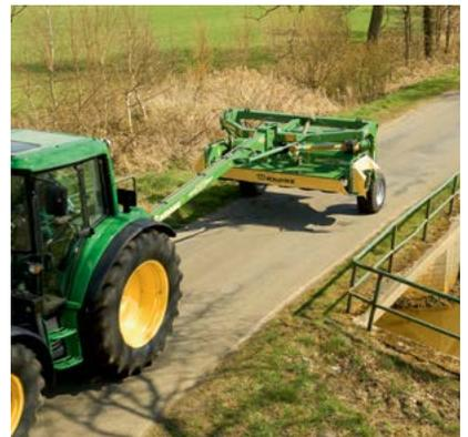
Se puede desplazar de un campo a otro a 40 km/h. En posición alineada, EasyCut 3210 CV y CRi pueden desplazarse por vías pública y su ancho de transporte de 3,00 m no requiere ningún permiso especial.
