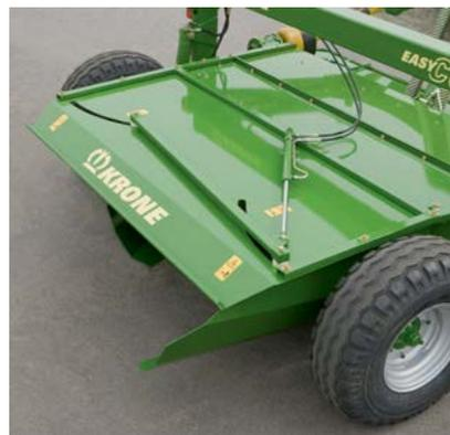
Las dos placas de hileras, al proporcionar un ajuste variable continuo, se controlan mediante un sistema de articulación compartida y un cilindro de efecto doble que sincroniza la acción a lado derecho o izquierdo.
