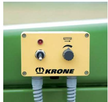
Comodidad del usuario: el usuario puede modificar cómodamente la velocidad de la correa desde la cabina accionando un potenciómetro giratorio que controla y la difusión y la colocación de la materia vegetal sobre la hilera ya formada o junto a ella.
