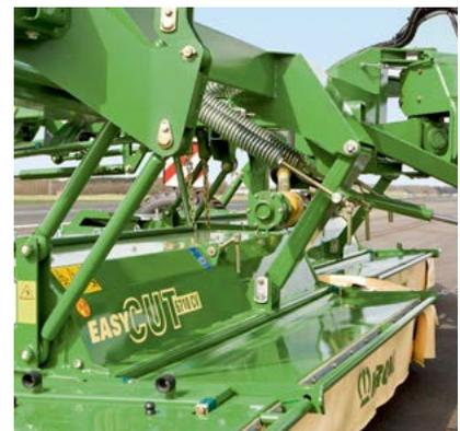
DuoGrip: un sistema que permite que cada segadora oscile por su centro de gravedad y siga al tractor en un bastidor doble. La presión sobre el terreno se mantiene por todo el ancho de trabajo y se controla regulando los muelles de tensión del brazo oscilante.
