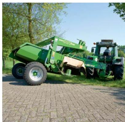
Amplio espacio de separación: los cilindros de efecto sencillo elevan el bastidor doble y la segadora para su transporte por carretera, así como cuando cruza las hileras. Durante el transporte por carretera los cilindros están bloqueados.
