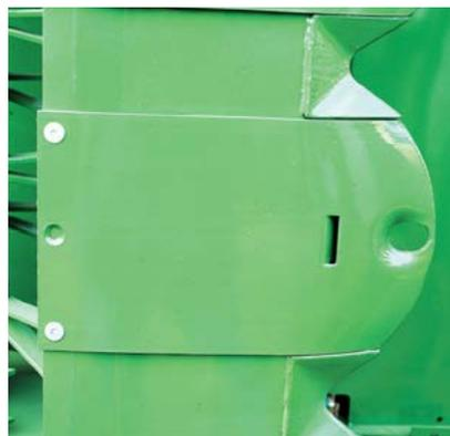
Los patines de gran ancho, que se deslizan sobre la capa de hierba, están fabricados con acero templado y atornillados a la barra de corte para proteger tanto la unidad como la capa de hierba. Existen patines de corte alto para generar un rastrojo con una longitud de más de 80 mm. En función de la instalación, estos patines aumentan la altura de corte en 30 mm o 50 mm.
