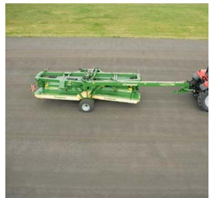
Amplios anchos de trabajo o anchos de transporte estrechos: en cuestión de segundos la máquina pasa de posición de trabajo a posición de transporte y viceversa. No es necesario bajarse del tractor. No
