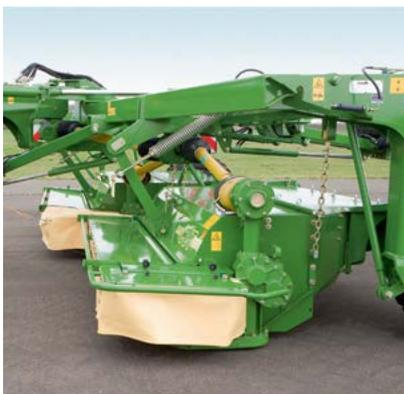
Excelente adaptación al terreno: gracias a dos barras de corte desplazadas en lugar de una barra de corte de ancho completo. Las dos unidades funcionan de manera independiente entre sí y se adaptan a cualquier contorno del terreno. EasyCut 6210 CV es la máquina para producir forraje de calidad.
