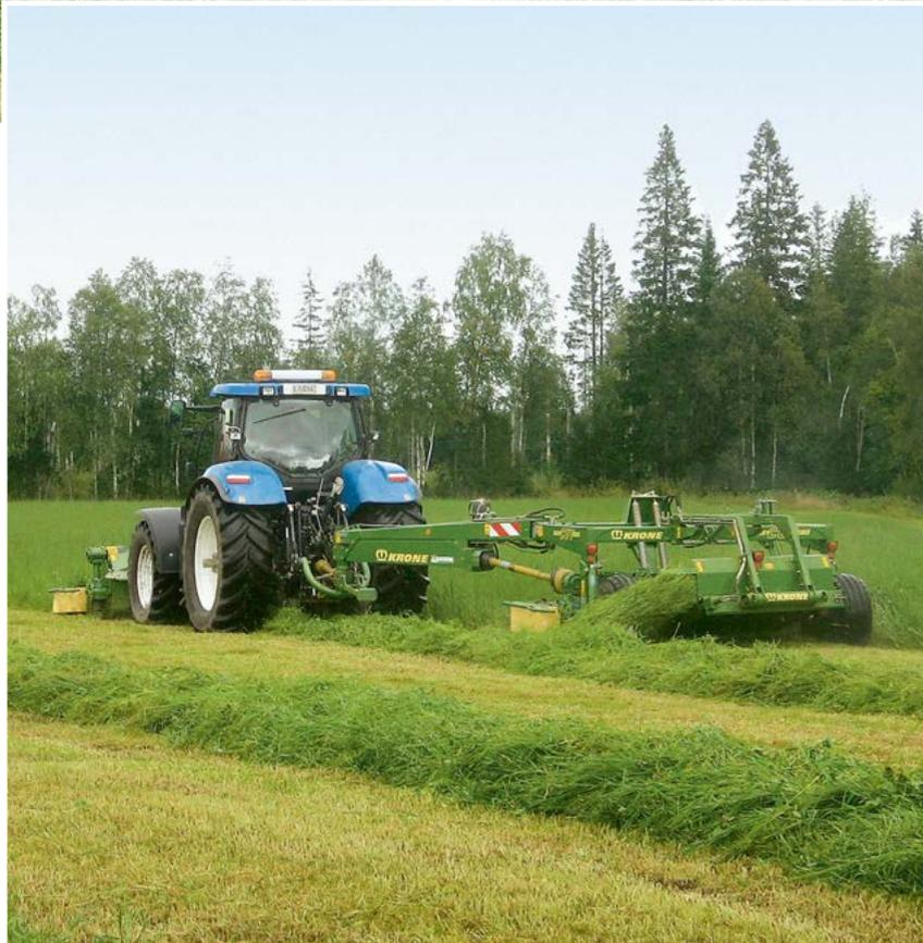
La combinación EasyCut 32 CV y 32 CRi produce una hilera doble en una única operación. El agrupador de hileras transversal sitúa la materia sobre o junto a la hilera que forma la segadora frontal. Al eliminar las pasadas del henificador y el rastrillo, la combinación aumenta la eficacia ahorrándole tiempo y dinero. Estos datos sugieren que agrupar dos hileras e una es una estrategia rentable que justifica la inversión en un agrupador de hileras transversal.
