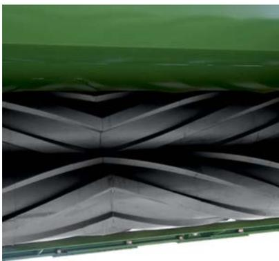
Voraz: los rodillos del acondicionador de diámetro grande y perfil cuneiforme se engranan para aplastar, rallar y doblar la materia vegetal con gran intensidad.
