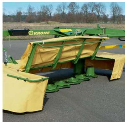
Fácil de mantener: La sección frontal del bastidor se pliega para que sea posible acceder a los discos con fines de limpieza o sustitución cómoda de las cuchillas.
