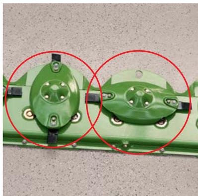
Cortes excelentes: las cuchillas de 112 mm montadas en los discos individuales en disposiciones alternas proporcionan un generoso solapamiento. Las piezas de tope contra impactos están soldadas entre los patines para impedir que se dañe la barra de corte y proporcionar un corte excelente.
