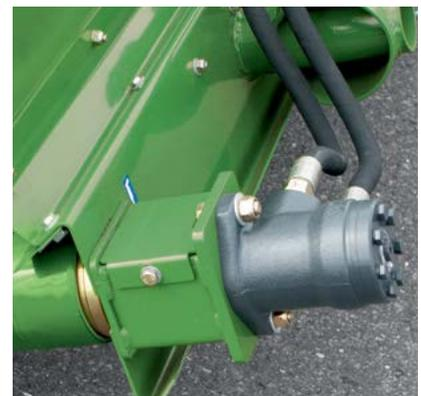
Motor potente y velocidad del agrupador de variación continua: la combinación perfecta para adaptar el ancho de la hilera a las necesidades de la cosechadora posterior. El motor se apaga automáticamente cuando se eleva la correa y vuelve a arrancar, también de forma automática, cuando la correa retoma la posición de trabajo.
