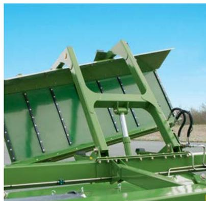
Un sistema ideal, un cilindro de efecto sencillo eleva el transportador transversal cuando lo desactiva una válvula de inversión y lo vuelve a activar cuando el cilindro vuelve a situar la unidad en la posición de trabajo.
