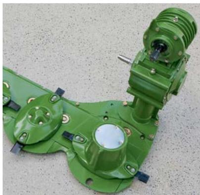
De diseño inteligente, la barra de corte se acciona a través de un engranaje de ángulo recto, situado justo detrás del tambor superior interno para garantizar un funcionamiento sin atascos en los promontorios y en terrenos de superficie irregular.
