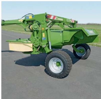
Rápida: la segadora se eleva y gira por medios hidráulicos hasta la posición central para su transporte por vías públicas, posición en la que dispone de una gran separación respecto al suelo y que permite pasar sobre surcos profundos e hileras.
