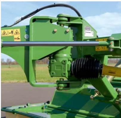
Las transmisiones sin correas garantizan que la potencia de tracción fluye con suavidad hasta la barra de corte y el acondicionador a través de engranajes y árboles de transmisión, gracias a dos engranajes giratorios. La protección frente a sobrecargas integrada en el accionamiento aporta tranquilidad al usuario.
