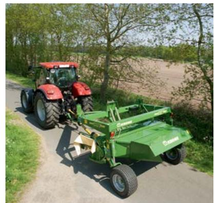
Rápida velocidad por carretera de 40 km/h. Al no superar el ancho legal de transporte de 3,00 m, los modelos EasyCut 2800 CV/CRi, 3200 CV/CRi y 3201 CV no requieren ningún permiso especial para desplazarse por vías públicas.
