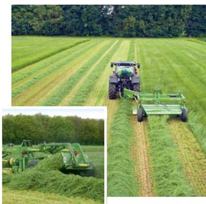
Dos en una: EasyCut 3200 CV, 3201 CV y 3210 CV están disponibles con agrupador de hileras transversal, EasyCut 2801 CV, 3200 CV, 3201 CV y 3210 CV con control hidráulico de chapas hileradoras para agrupar dos hileras en una o situar dos hileras una junto a otra.
