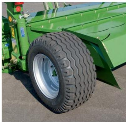
La segadora arrastrada EasyCut con barra de tracción de montaje lateral, que siega de forma continua sin detenerse nunca, realiza giros en el mismo sitio gracias al engranaje oscilante y a la corta barra de tracción, eliminando así la necesidad de desplazarse marcha atrás en las esquinas.
