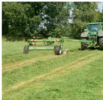
Los modelos EasyCut 3210 CV, 3210 CRi y 4013 CV de lanza central con control hidráulico para situarse a la derecha o izquierda del tractor. Son las máquinas perfectas para segar grandes extensiones.
