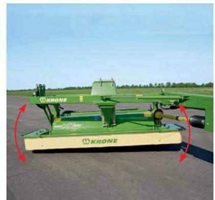
Existe un gran espacio de oscilación en los dos extremos de la barra de corte que permite a la unidad adaptarse a cualquier contorno del terreno. Como la segadora oscila en un bastidor doble, se adapta con precisión al terreno con la finalidad de producir un forraje limpio y proteger la capa de hierba.
