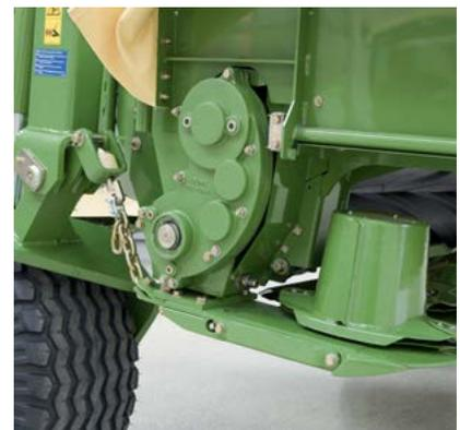
Dos rodillos, dos accionamientos. El rodillo superior está traccionado con un grupo independiente situada en el extremo derecho de la barra de corte y está sincronizado con el rodillo inferior.
