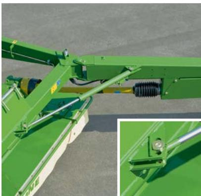
Cómoda y rápida: el usuario modifica por medios hidráulicos la posición de trabajo o de transporte de la segadora cómodamente desde su asiento. El cilindro giratorio se puede montar en diferentes posiciones que permiten al usuario aprovechar el ancho completo de guía del tractor de arrastre.
