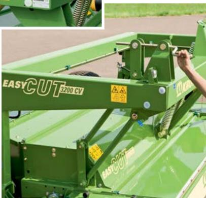
Rápido y sencillo. Esta manivela controla la altura de corte. Los modelos EasyCut 2801 CV y EasyCut 3201 CV pueden estar equipados con un cilindro hidráulico opcional que inclina la segadora cuando pasa por zonas hundidas.
