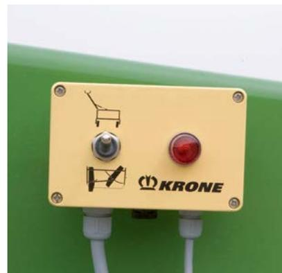
Las placas de las hileras giran hacia la derecha o la izquierda, la barra de tracción bascula hacia dentro o hacia fuera en la posición de trabajo o de transporte. El usuario selecciona las funciones individuales en el cuadro eléctrico de mandos.
