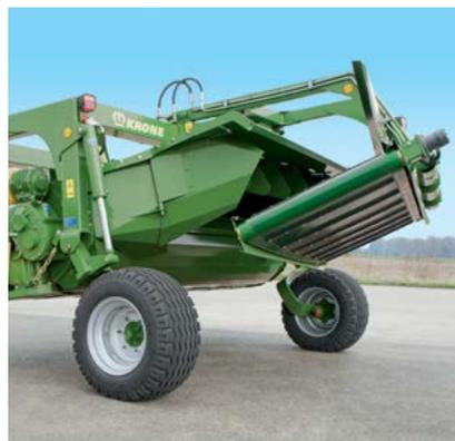
No se aceptan las pérdidas. Todas las versiones del agrupador transversal de las segadoras de discos arrastradas EasyCut CV incluyen un depósito de acero situado debajo del acondicionador de mayales de acero en V, que recoge hasta la más mínima cantidad para llevarla hasta la hilera.
