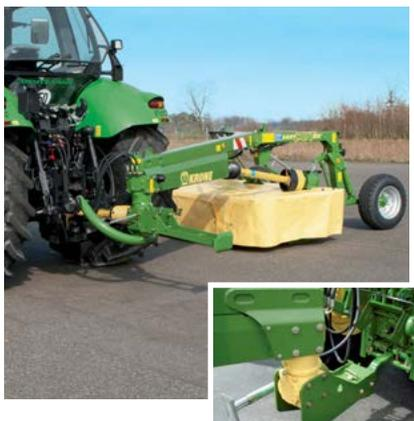
Maniobrable. Equipada con una lanza de montaje lateral y un engranaje oscilante, la unidad puede cortar en cualquier curva. El enganche de dos puntos se acopla a los brazos de conexión regulables en altura, si bien la barra de tracción de flotación es la opción de preferencia en algunos países.
