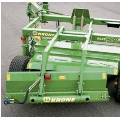
El agrupador de hileras transversal está suspendido por sólidas barras que proporcionan una estabilidad máxima cuando se trabaja con materia vegetal pesada, en terrenos irregulares o en pendientes. Cuando la segadora forma una única hilera o hileras anchas, estas barras desplazan la unidad hacia arriba para sacarla de la posición de trabajo.
