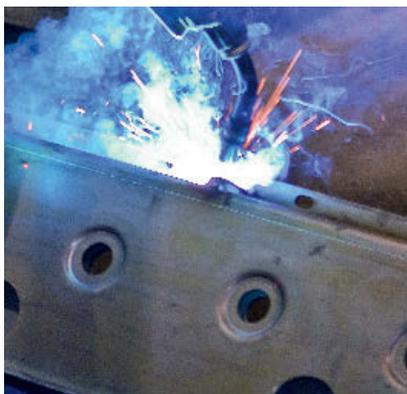
Las sólidas barras de corte totalmente estancas de KRONE están soldadas por robots avanzados y cuentan con la tecnología CNC para proporcionar una estructura de la máxima calidad. Después de todo, la barra de corte es el núcleo de una segadora de discos.
