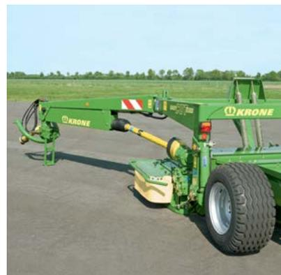
Velocidad de toma de fuerza constante: gracias a un accionamiento formado por árboles de transmisión y engranajes, que transmite con eficacia la potencia a los discos, incluso cuando se trabaja con materia vegetal pesada y con anchos de trabajo amplios. El engranaje principal de todas las segadoras EasyCut alcanza una toma de fuerza de 1000 rpm en el equipamiento de serie.
