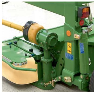
Transmisión: la potencia de accionamiento llega hasta el acondicionador de rodillos directamente y sin resbalamiento a través de engranajes. Los engranajes que accionan el rodillo inferior están integrados en la caja de cambios de la barra de corte situada detrás del tambor superior izquierdo.
